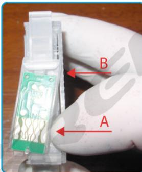
Coloque el cartucho de manera vertical y con el chip mirando hacia usted.
