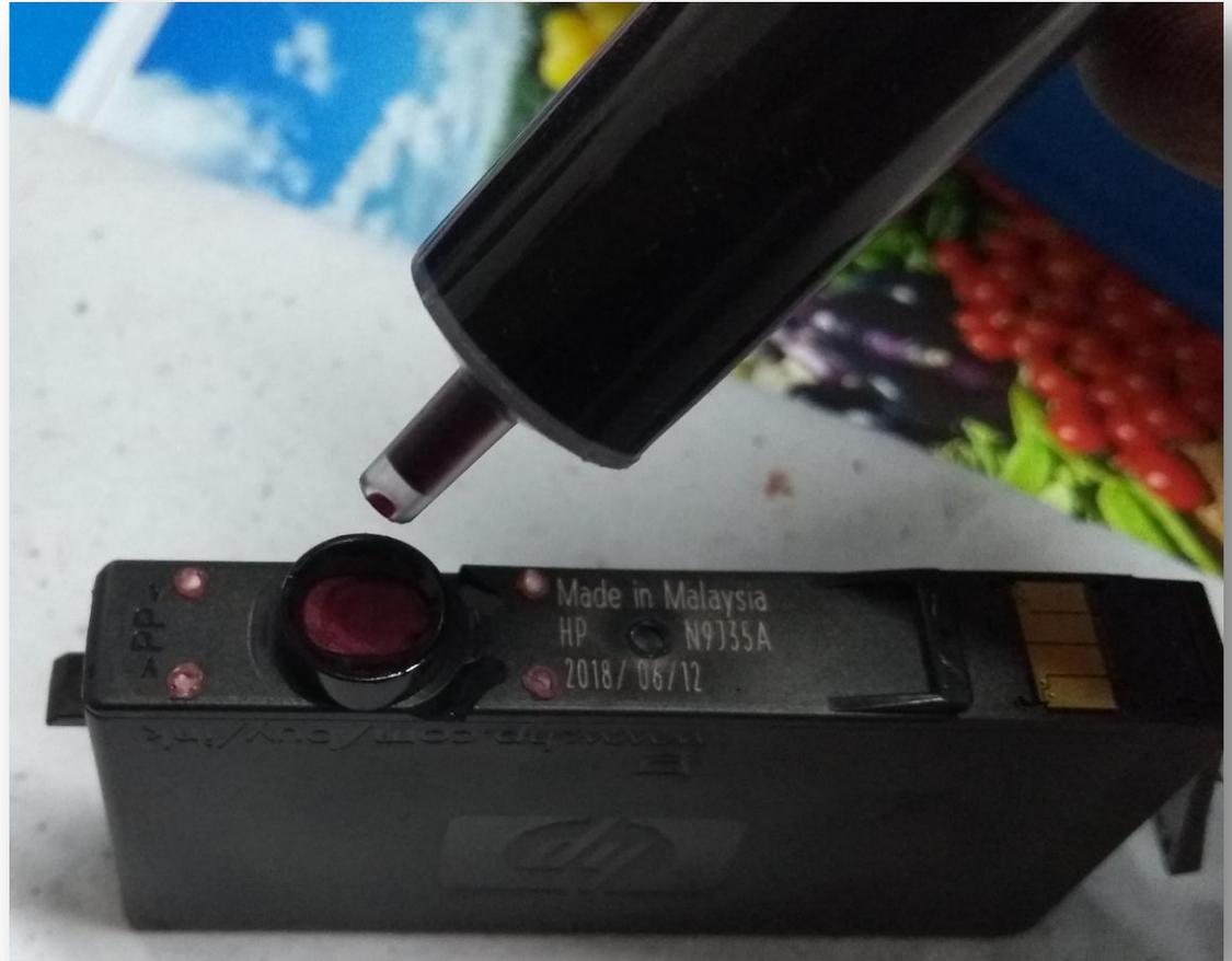
LA ESPONJA IRA ABSORBIENDO LA TINTA A MEDIDA QUE LA VAYA INYECTANDO. CUANDO LA ESPONJA NO ABSORBA MAS, SEQUE EL RESTO DE TINTA Y COLOQUE EL CARTUCHO EN LA IMPRESORA.
