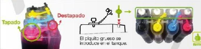
**C** Mantenga los tanques a la siguiente altura: 3cm por arriba de la base de la impresora.
