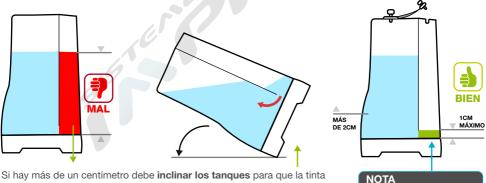
Si hay más de un centímetro debe **inclinar los tanques** para que la tinta pase del compartimiento fino al ancho. El compartimiento de la tinta (el mas ancho) no debe tener NUNCA menos de 2 cm de tinta porque se corre el riesgo que el sistema comience a trabajar con aire y esto, a su vez, dañe los inyectores de la impresora.
