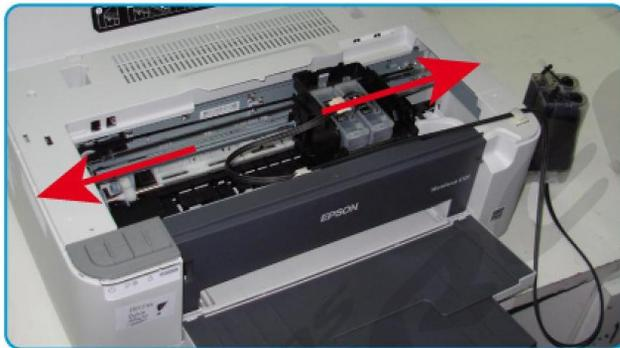
Mueva manualmente el carro de impresión de un extremo al otro de la impresora, verificando que la manguera no se atasque ni retuerza en ningún punto del recorrido del carro.
