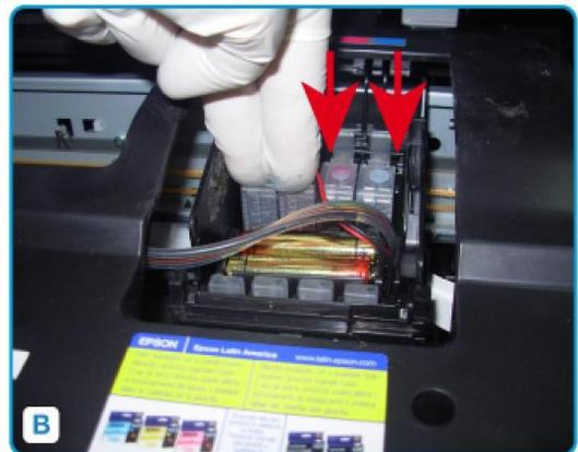
Colocar el Clip Adhesivo ( A ) y la Traba en forma de "T" ( B ), y asegurar la manguera a las mismas (ver el esquema con las medidas para saber exactamente en donde pegarlas).
