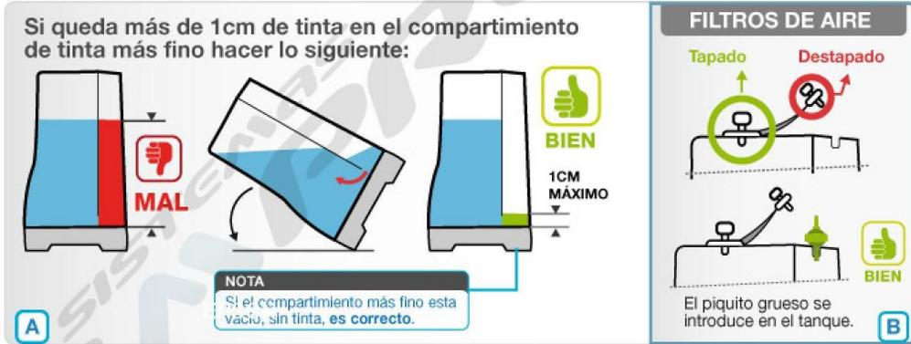
**Mantener los tanques a la misma altura que la base de la impresora.**
