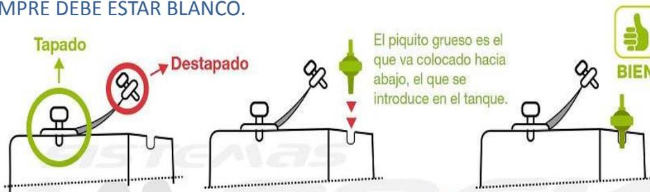
**PASO 3.** LOS TANQUES DE TINTA DEBEN ESTAR A LA MISMA ALTURA QUE LA IMPRESORA.
