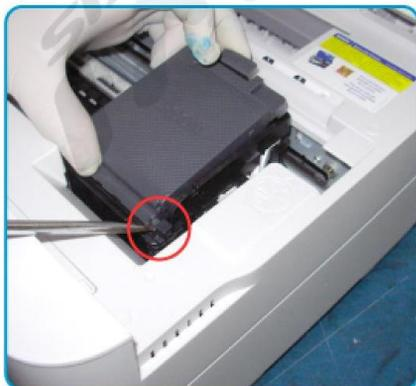
Retire la cubierta de los cartuchos del carro utilizando un destornillador haciendo palanca en uno de los extremos de la bisagra.
