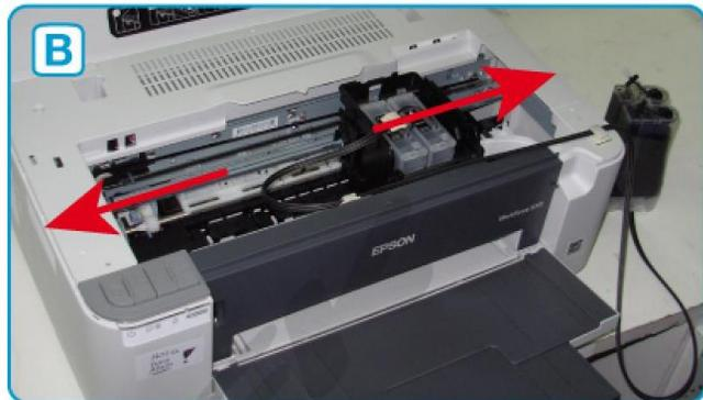
Mantenga los tanques a **3cm por arriba de la base de la impresora**. Debe colocar el sistema arriba de la caja de cristal (tarjetero) para lograr esa altura.
