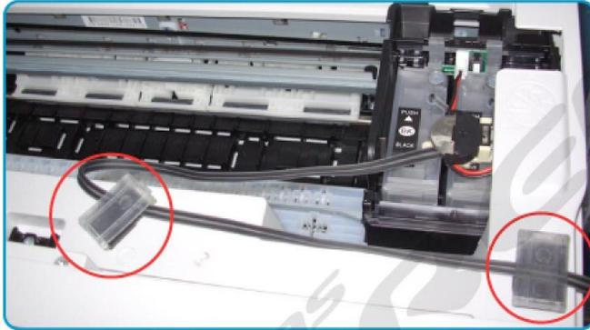
Ajuste las mangueras a los clips adhesivos colocados en el punto 3 como se ve en la imagen.
