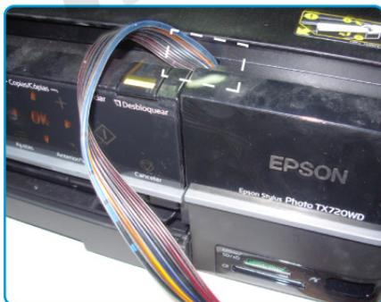
1. C y D. Coloque la grampa adhesiva en el borde superior derecho, casi en el ángulo frontal entre el scanner y el frente de la impresora, pase y asegure la manguera a esa grampa.
