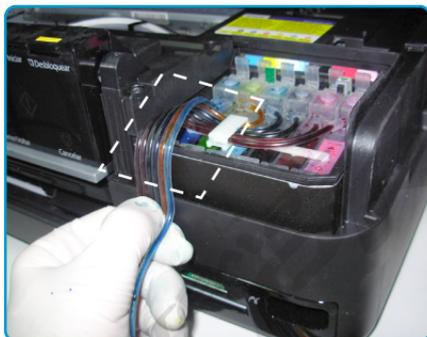
2. B y C. Cierre lentamente la tapa verificando que no tiree ni aplaste la manguera contra el tope de abajo.
