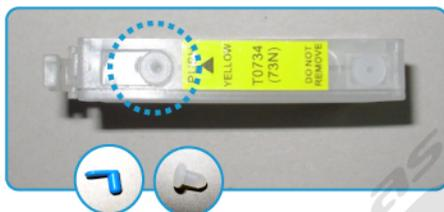
**PASO 02** Cargar los cartuchos con tinta (en el orificio destapado) con una jeringa con aguja.
