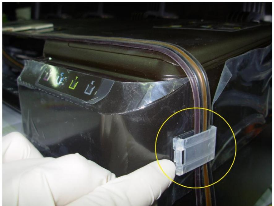
Coloque el SUPLEMENTO ACTIVADOR del Sensor de tapa en el orificio que se encuentra en la carcasa, hacia el lado izquierdo del indicador de tinta Magenta.
