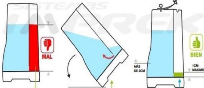
Si hay más de un centímetro debe **inclin** los tanques para que la tinta pase del compartimiento fino al ancho. El compartimiento de la tinta (el mas ancho) no debe tener **NUNCA** menos de 2 cm de tinta porque se corre el riesgo que el sistema comience a trabajar con aire y esto, a su vez, dañe los inyectores de la impresora.
