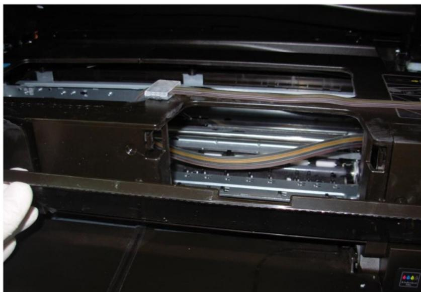
Coloque el activador de sensor de tapa en el orificio que se encuentra del lado derecho de la impresora sobre la carcasa.
