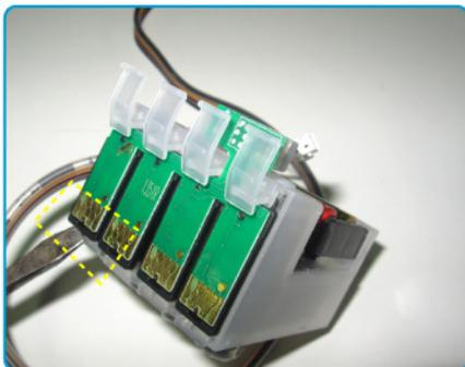
Con un destornillador plano haga palanca en la parte inferior del chip para descalzarlo de las trabas (El chip debe salir junto con la base plástica de color negro)
