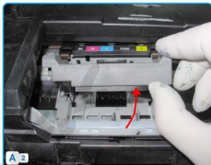
B. Luego retire el cabezal
