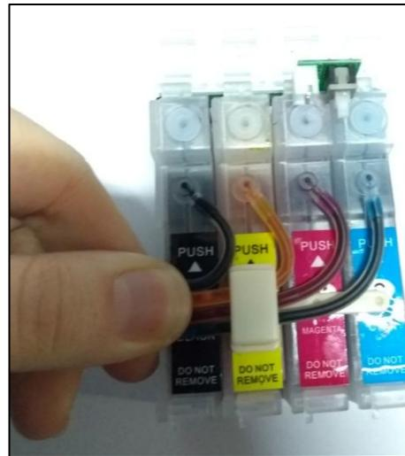
Si alguna de las mangueras forma una “V” (como muestra la imagen de la manguera amarilla), solo debe tomar las mangueras y desplazarlas al menos 0.5cm hacia donde se hace la curva para que deje de estrangular y eso impida el paso de la tinta.
