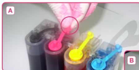
► Tape el orificio mas fino de los tanques
